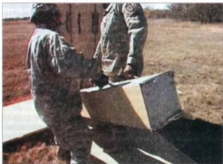
Перезарядка контейнеров с управляемыми ракетами PAM и LAM может осуществляться вручную двумя военнослужащими
