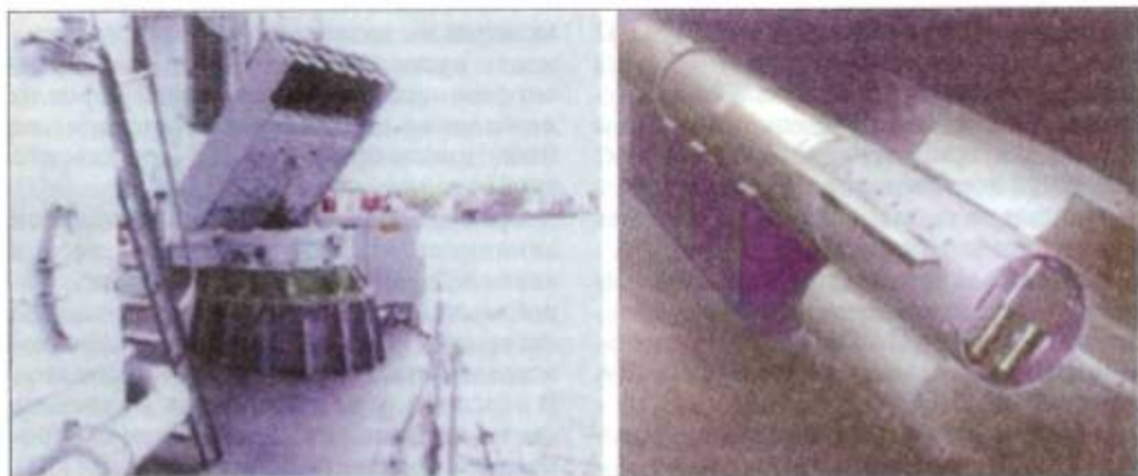
Рис. 5. Пусковая установка (слева) и прибор ГПД (справа) системы ПТЗ SLAT
